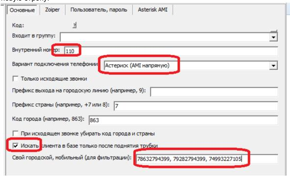
Вносим внутренний номер и выбираем вариант подключения телефонии «Астериск (АМІ напрямую)»
